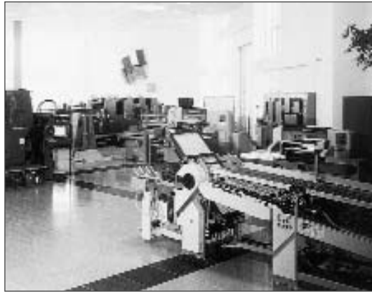
Hình 2.38: Máy cắt và gấp tại phân xưởng thành phẩm.
