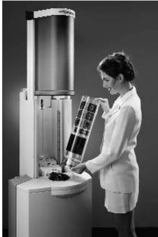
Hình 2.25: Máy quét dạng trống xoay kiểu đứng
