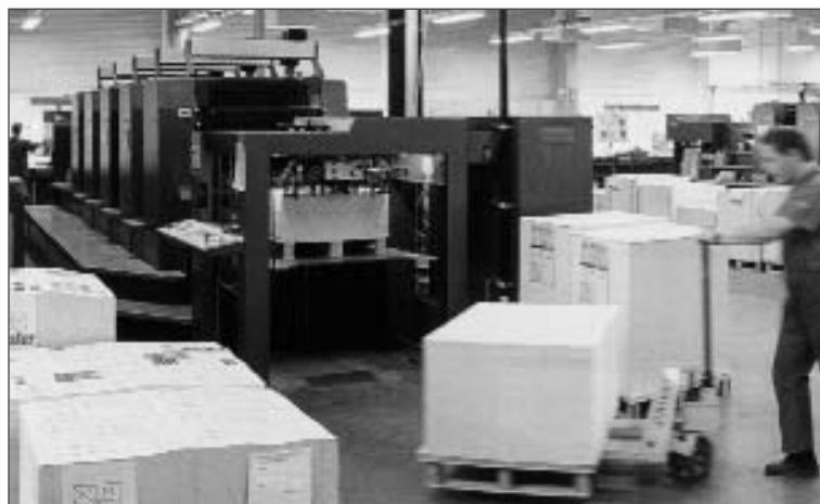
Hình 2.41: Vận chuyển giấy cho máy in Offset từ rời tại phân xưởng in.
